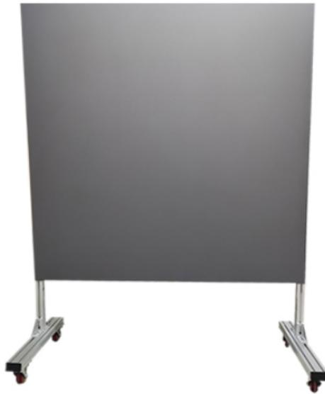
激光雷达通过反射率标定校准用来提高激光雷达传感器对物体以及距离的感知精度，反射率标定校准通过激光雷达标定板来实现。激光雷达反射率校准常用的是1mx1m尺寸的雷达标定板，此类雷达标定板完美的朗伯特特性，不同于普通的颜料纸卡、涂料等，是标准的朗伯面。一般采用的低中高反射率组合来校准，常用的组合是10%+50%+90%这三个反射率，颜色黑（10%）灰（50%）白（90%）反射率由低向高过渡[905nm或1550nm等是常用的激光雷达测试波长。瑞科光电激光雷达标定板反射率涵盖了400-1700nm宽光谱范围，出厂附带反射率检测报告。远距离的测试还可以定制1.5mx3m或者更大尺寸的反射板。空间遥感-激光测距板激光雷达定标板可以应用于无人驾驶距离测试。
